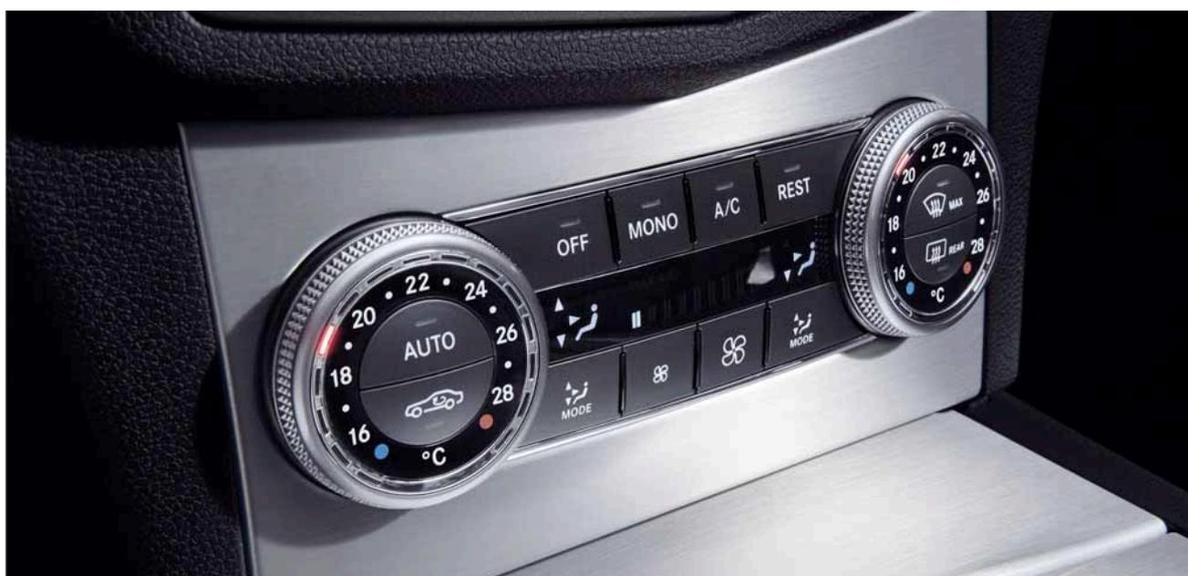
*Climatiseur automatique confort trois zones THERMOTRONIC*
